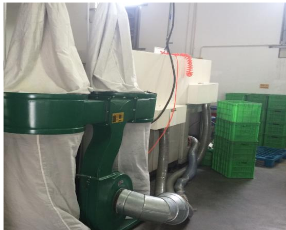
图 10.1-4 切割粉尘收集及处理设施图
